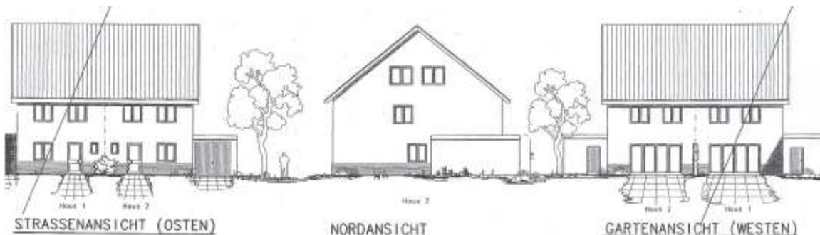
Unser Beratungsentwurf greift das vorgegebene Grundrisskonzept auf. Der quadratische Grundriss und die damit verbundene breite Giebelgestalt kann sich durch die Gliederung des Baukörpers und einem steilen Satteldach mit einer Dachneigung von min. 45° verträglicher ins Siedlungsbild einfügen.
