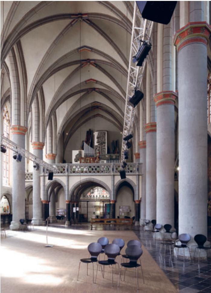
normalen „Verkehrsflächen“. Begleitet wird die Veranstaltungsfläche von zwei vom Gewölbe herabhängenden Traversen, die zur Befestigung von Scheinwerfern und Lautsprechern dienen.
