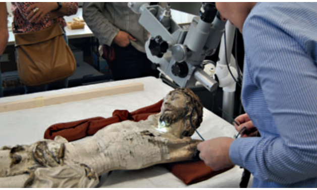
2 Der Blick ins Objekt: Teilnehmer der Führung betrachten durch das Technoskop die Farbfassungsschichten eines Christuskorpus.
