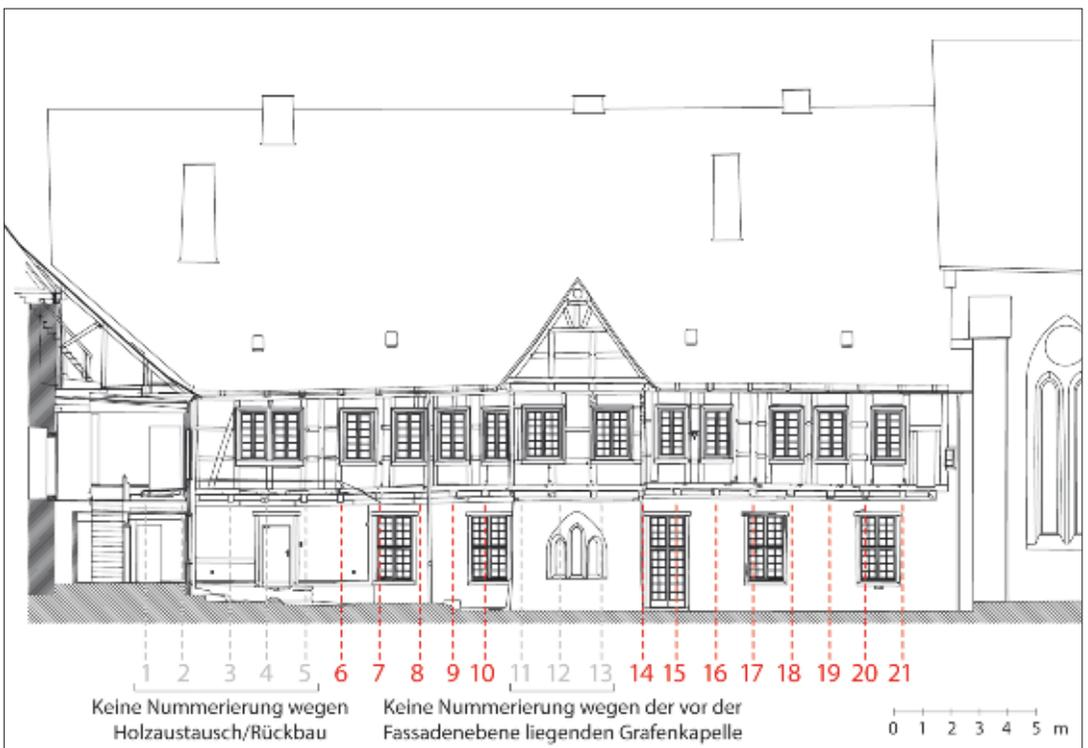
7 Ostflügel, Ostfassade von 1655/56 mit Nummerierung der Gebinde des Fachwerkobergeschosses.
