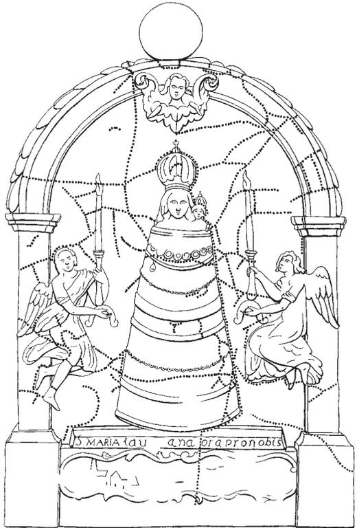
4 Sassenberg, Brookstr. 9. Kartierung der vorderseitig offenen Risse mittels gepunkteten Linien vom 12.04.2006.
