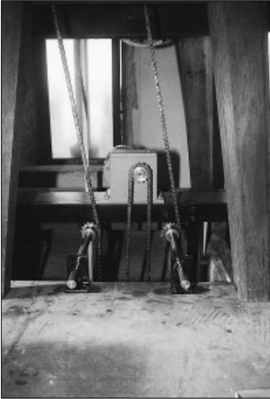
10. Einer der unterhalb des Uhrwerks montierten Getriebemotoren für den Aufzug. 2002.
