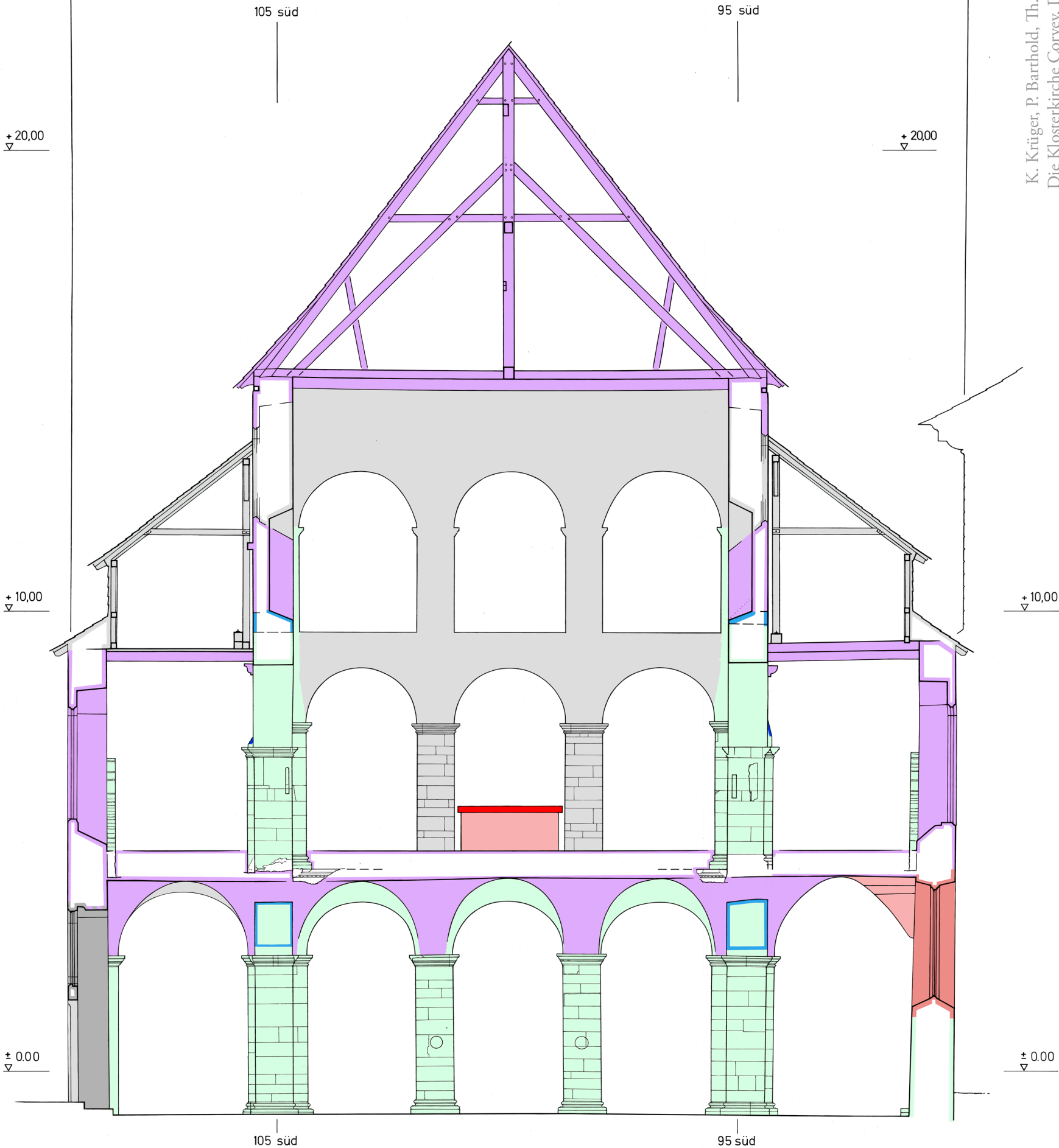
Plan 28 Corvey, Westbau. Querschnitt durch das Ostjoch, Blick nach Westen auf die Arkadenwand. Bestand 2011 mit Eintragung der Bauphasen und von Befunden der Untersuchungen zwischen 1950 und 2010 sowie des 1961 abgebrochenen Johannesaltars. Maßstab 1 : 100
