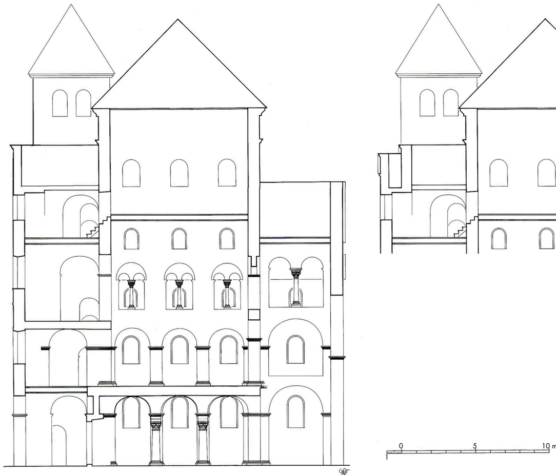
Abb. 877 Corvey, Längsschnitt durch den karolingischen Westbau mit Blick nach Norden. Rekonstruktion und Variante von U. Lobbedey dazu (rechts).
