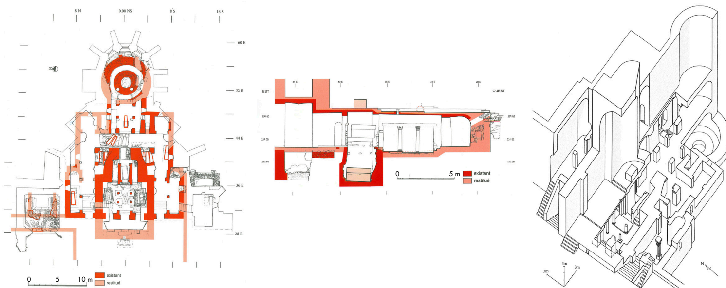
Abb. 902 Auxerre, ehem. Benediktinerabtei Saint-Germain. Grundriss der karolingischen Ostteile mit erhaltenem Baubestand (links) und isometrische Rekonstruktion (rechts) sowie Schnitt durch die Krypta von Westen nach Osten.
