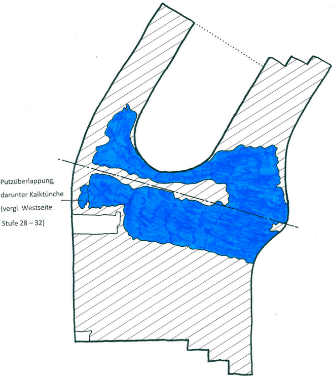
V.4.27 Südturm, Kartierung der vorhandenen Putze, Ostseite, Stufen 21–24.
